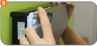
Retire la cubierta de plástico del centro de cableado Quantum-RF.
