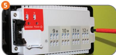
Reemplace la placa de conexión blanca.
