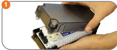
Retire la cubierta de plástico. Abra los cuatro tornillos blancos solo con un cuarto de vuelta.
