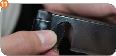
Empuje hacia afuera el corte en la parte inferior de la cubierta de la extensión de cableado-RF Quantum.
