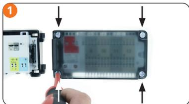
1 Retire la tapa superior de la extensión del centro de cableado y desatornille la carcasa principal.
